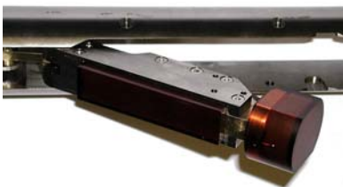
Neu entwickelter Kippkopf der 42 mm Sonde BSG
