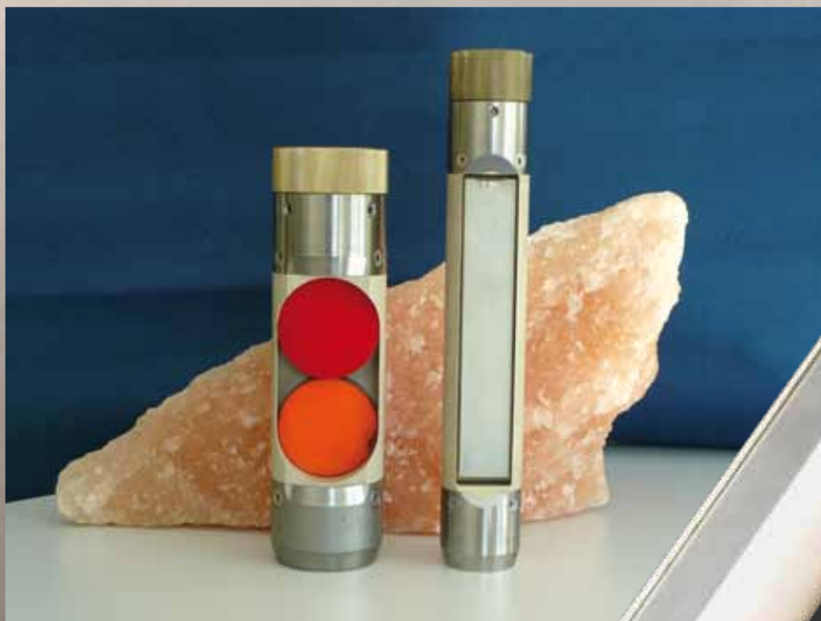
Größenvergleich zwischen Standard BSF-Messkopf (links) und der neuen Bohrlochsonde BSM-B (rechts).
